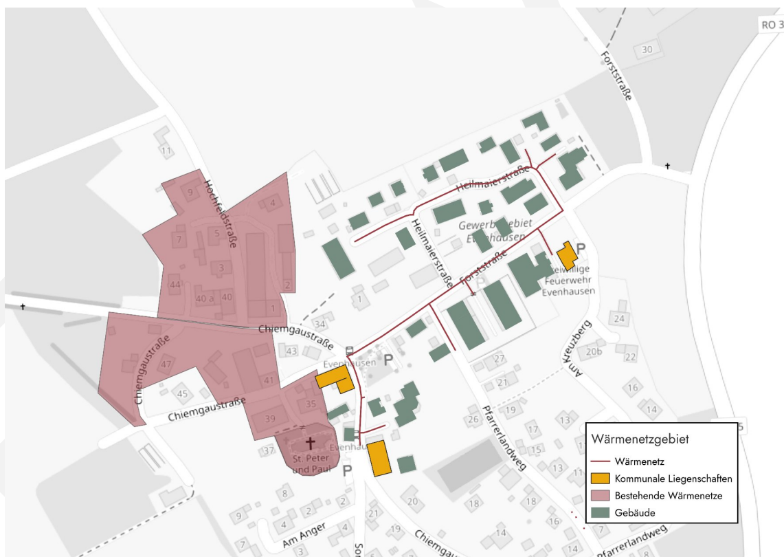
Abbildung 5.6: Detailbetrachtung Evenhausen, möglicher Trassenverlauf eines Wärmenetzes, eigene Darstellung, Hintergrundkarte [1]
