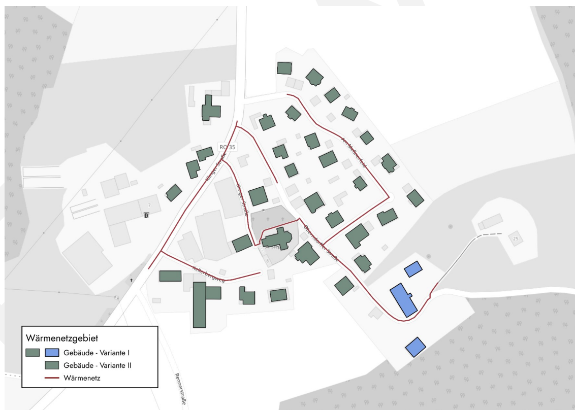
Abbildung 3.3: Detailbetrachtung Stephanskirchen, möglicher Trassenverlauf eines Wärmenetzes, eigene Darstellung, Hintergrundkarte [1]
