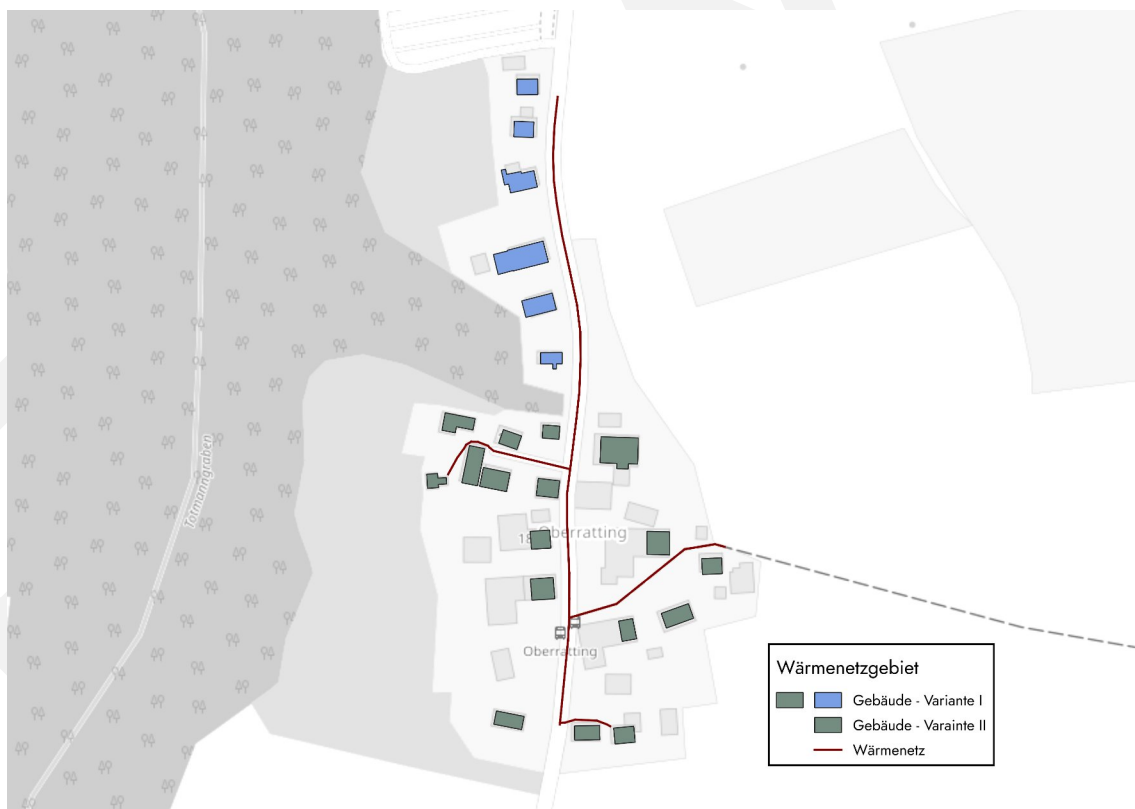
Abbildung 3.4: Detailbetrachtung Oberrating, möglicher Trassenverlauf eines Wärmenetzes, eigene Darstellung, Hintergrundkarte [1]
