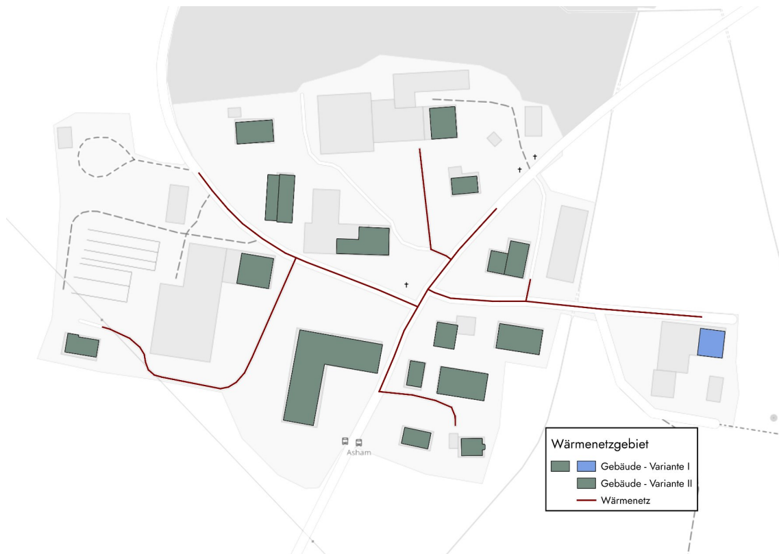
Abbildung 3.5: Detailbetrachtung Asham, möglicher Trassenverlauf eines Wärmenetzes, eigene Darstellung, Hintergrundkarte [1]
