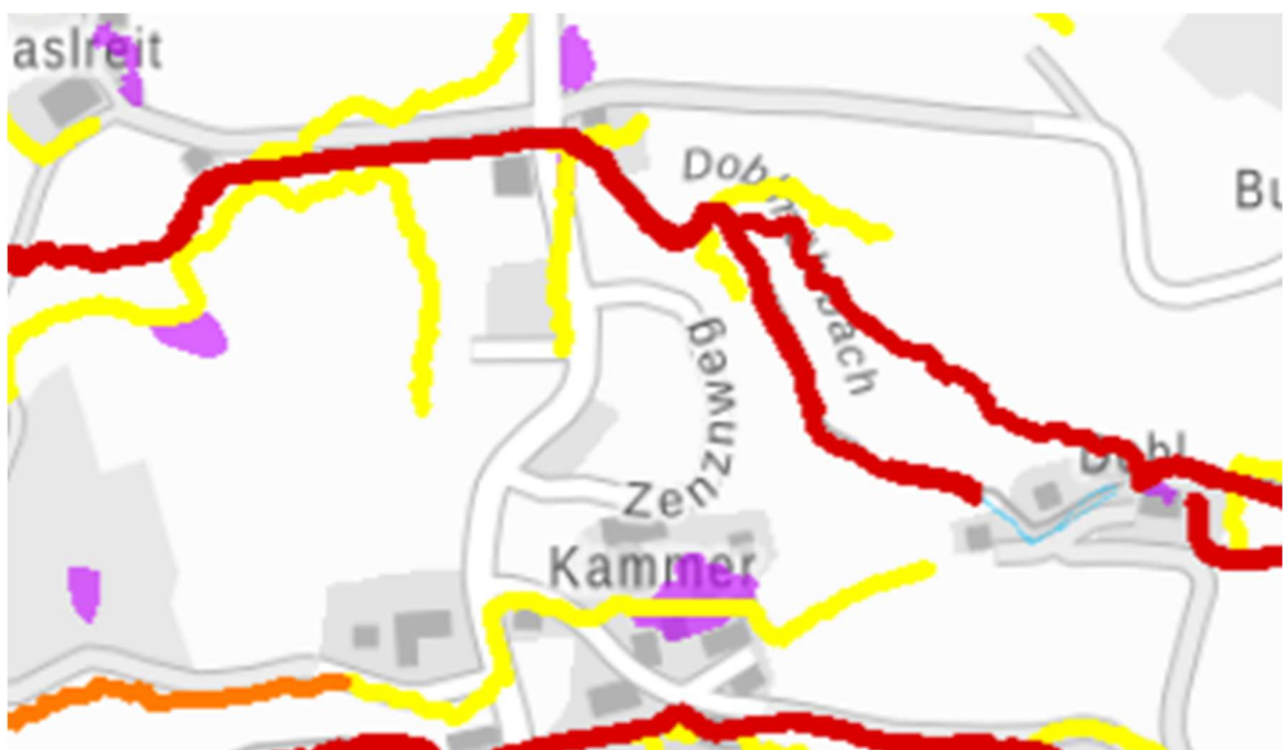
Abb. 4: Ausschnitt Umwelt-Atlas mit Karteninhalt „Oberflächenabfluss und Sturzflut“ Darstellung „Mäßiger Abflussbereich“ (gelb) und „Starker Abflussbereich“ (rot) im Bereich des Ortsteil Kammer – ohne Maßstab
