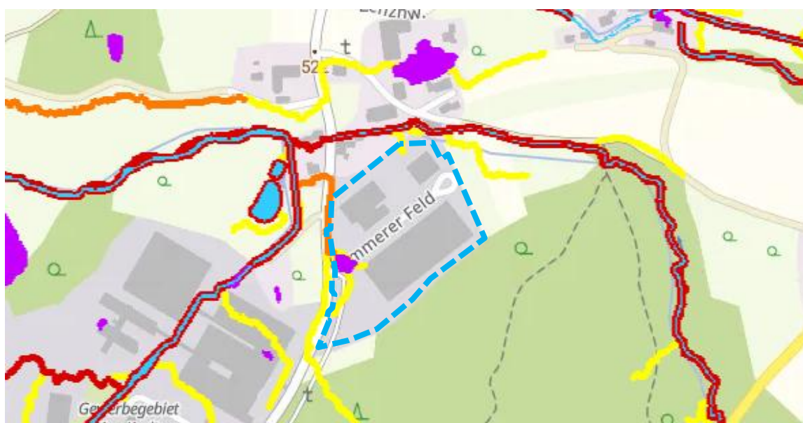
Abbildung 4: Ausschnitt Umwelt-Atlas mit Karteninhalt „Oberflächenabfluss und Sturzflut“ mit Darstellungen von „Mäßiger Abflussbereich“ (gelb), „Erhöhter Abflussbereich“ (orange), „Starker Abflussbereich“ (rot) und Aufstaubereich (lila) im und um den Planungsumgriff (blau) – ohne Maßstab
