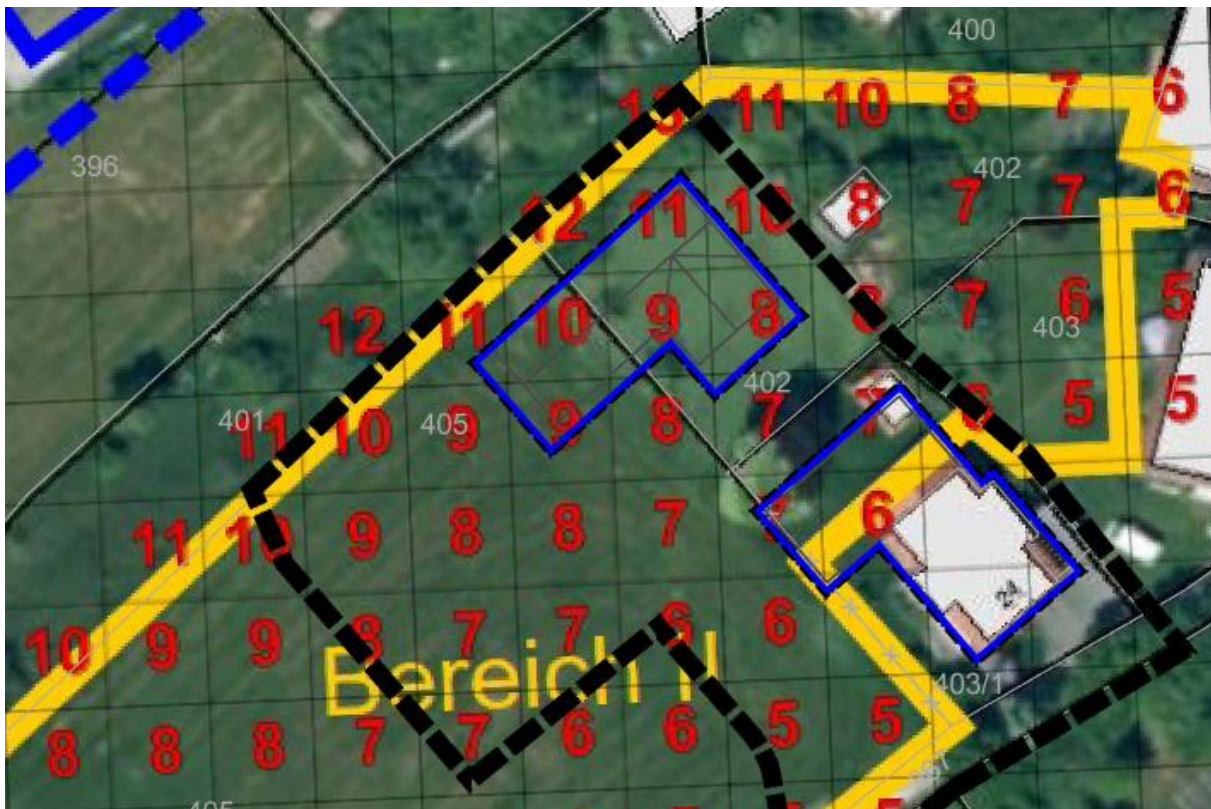
Abb. 3 Häufigkeit von Geruchstunden pro Jahr [%] ausgehend von der Biogasanlage mit Kennzeichnung des Geltungsbereichs (schwarz) und der Baugrenzen (blau; verändert)
