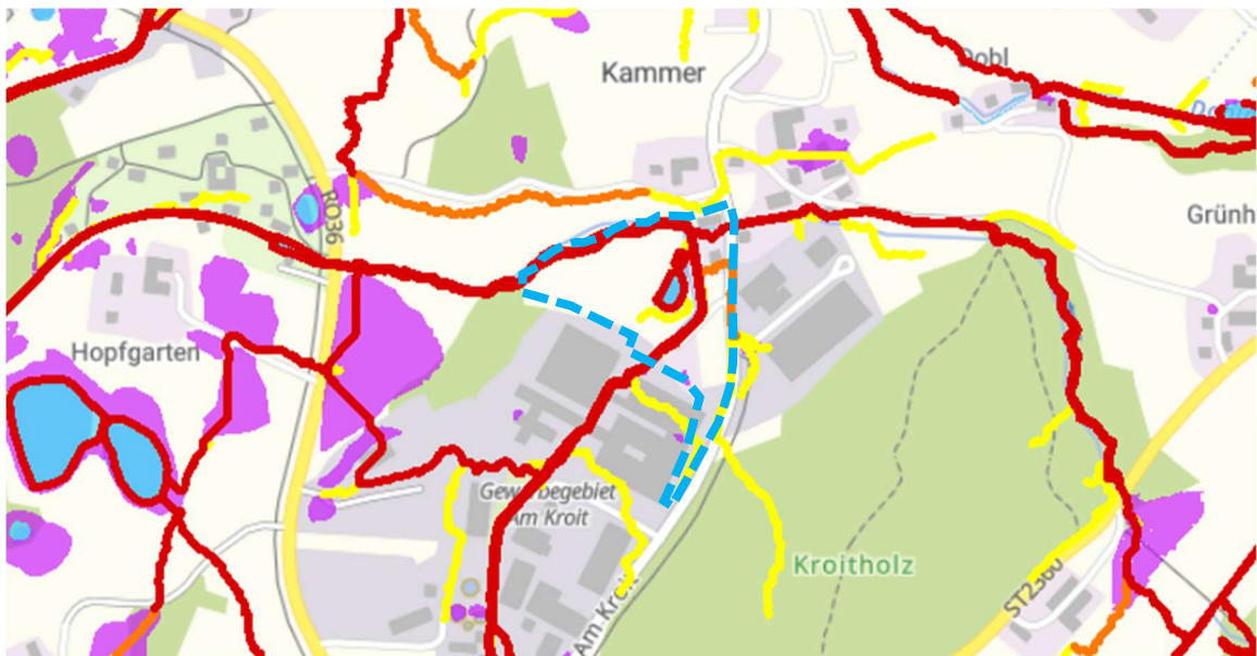
Abbildung 3: Ausschnitt Umwelt-Atlas mit Karteninhalt „Oberflächenabfluss und Sturzflut“ mit Darstellungen von „Mäßiger Abflussbereich“ (gelb), „Erhöhter Abflussbereich“ (orange) und „Starker Abflussbereich“ (rot) im Änderungsbereich (blau) – ohne Maßstab
