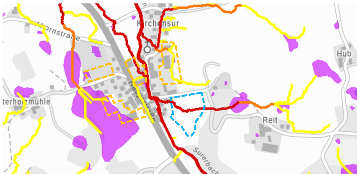
Abbildung 3: Ausschnitt Umwelt-Atlas mit Karteninhalt „Oberflächenabfluss und Sturzflut“ mit Darstellungen von „Mäßiger Abflussbereich“ (gelb), „Starker Abflussbereich“ (rot) und Aufstaubereiche (lila) im Änderungsbereich (blau) sowie den Klarstellungsbereichen (orange) – ohne Maßstab
